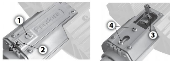
Рисунок 2. Схема установки светильника на кронштейн.
